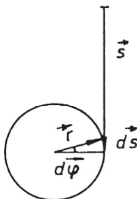
Figura 3: Relação entre a variação angular  $d\vec{\varphi}$  e a diminuição da altura  $d\vec{s}$  na roda de Maxwell.
