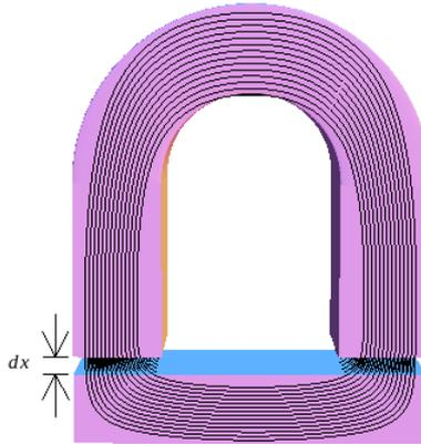
Considerando o circuito magnético formado pelas linhas de campo, e assumindo que um deslocamento  $dx$  da barra não altera o fluxo no circuito,
