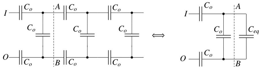
Assumindo que  $C_{eq}$  é a capacidade equivalente, retirar um conjunto de condensadores da extremidade da linha ( à esquerda da secção AB) não deve alterar muito o seu valor.
