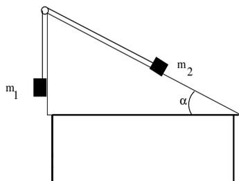
Figura 3.4: Sistema com duas massas ligadas em plano inclinado
