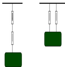
Figura 3.1: Ligação de dinamómetros em série e em paralelo
