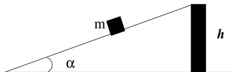
Figura 3.3: Movimento de translação ao longo de um plano inclinado sem atrito
