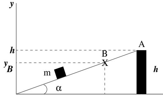
Figura 4.1: Movimento ao longo de um plano inclinado
