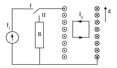
No interior da bobine é colocada uma espira quadrada de lado b e percorrida por uma corrente  $I_2$ , de acordo com a figura.
