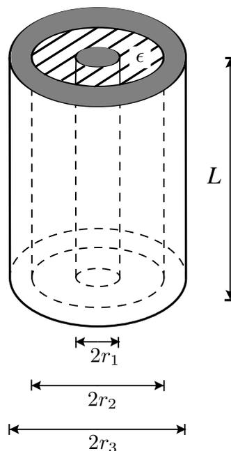
Logo a **carga total** na superfície interior do condutor exterior é  $Q_{2 \text{ int}} = -Q$ . Como o condutor tem carga total nula, devemos ter  $Q_{2 \text{ ext}} = Q$ .
