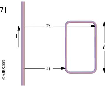
Calcular o coeficiente de indução mútua  $M$  entre o fio retilíneo infinito e o rectângulo, colocado paralelamente ao fio, representados na figura ao lado.
