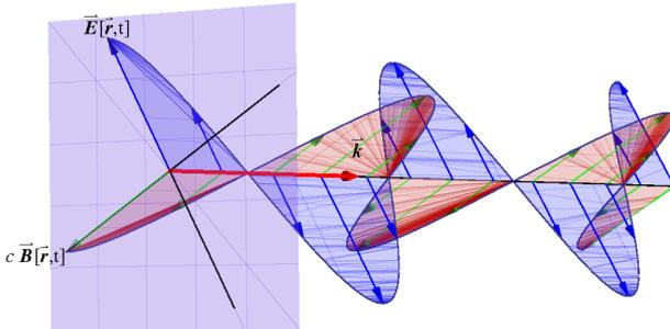
Numa onda plana o campo eléctrico é igual em todos os pontos dum plano perpendicular a  $\vec{k}$  (i.e. um plano de fase), mas oscila no tempo nesse plano. Na imagem vemos uma fotografia no instante  $t$  do valor do campo nos pontos sobre uma recta perpendicular a um plano de fase. Esta imagem repete-se para todos os pontos do plano de fase inicial. Igualmente representado está o vector  $c\vec{B}$  proporcional ao campo magnético.
