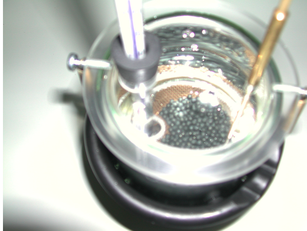
Fig. 8: Aspecto do calorímetro completo, com água e as esferas de chumbo.
