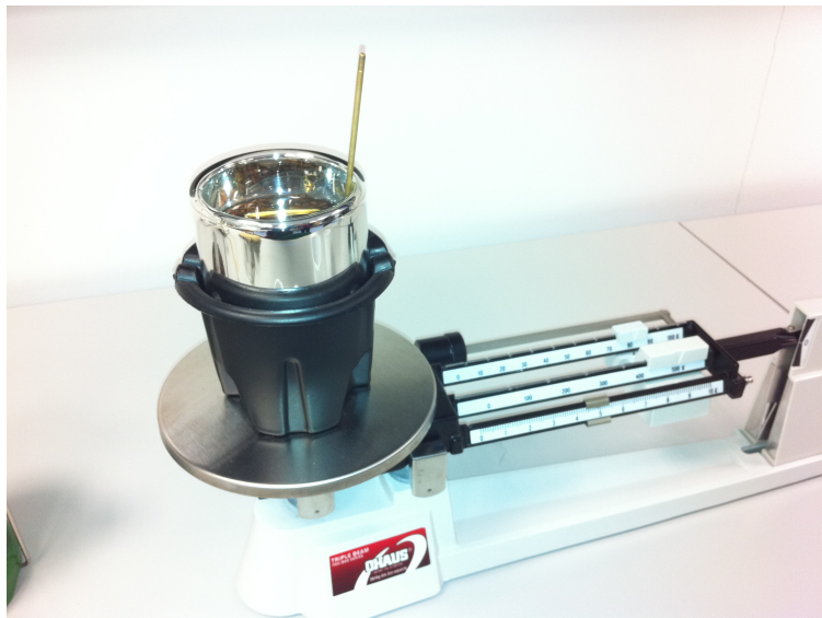
Fig. 9: Aspecto da balança numa operação de pesagem do calorímetro com água e o material.
